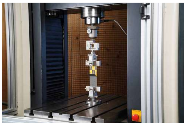
Campanha de testes sobre o desempenho da coesão e aderência em diferentes substratos de fitas adesivas acrílicas.
