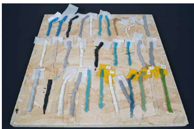
Campanha de testes para avaliação da aderência, coesão e elasticidade de diferentes colas e vedantes.
