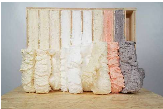
Análisis de las prestaciones de las espumas poliuretánicas sellantes.
