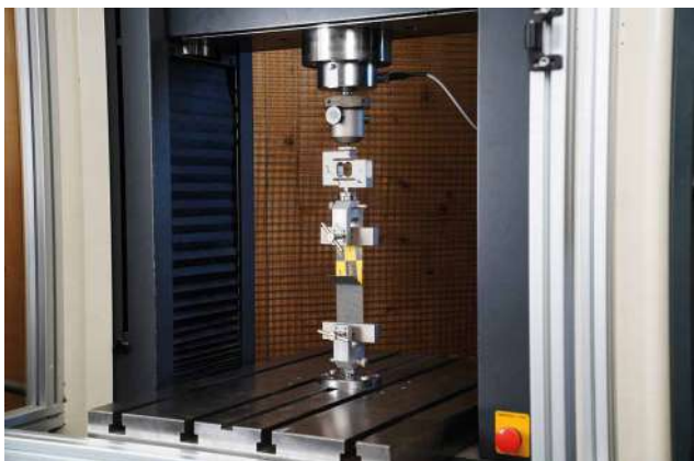
Campaña de pruebas para evaluar las prestaciones de cohesión y de adhesión en diferentes sustratos de las cintas adhesivas acrílicas.
