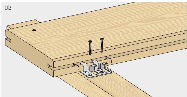
Inserir na ranhura o conector GAP4 de forma a que os dentes centrais do grampo fiquem aderentes à fresagem da tábuas.
