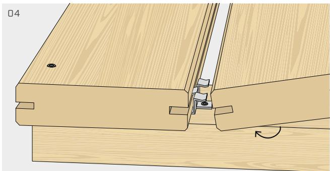
Colocar a próxima tábuas enfiando-a no conector GAP3 de forma que os dois dentes adiram à fresagem da tábuas.
