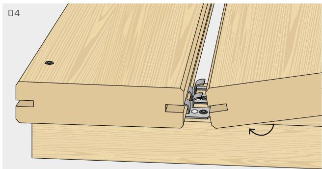
Colocar a próxima tábuas enfiando-a no conector GAP4 de forma que os dois dentes adiram à fresagem da tábuas.
