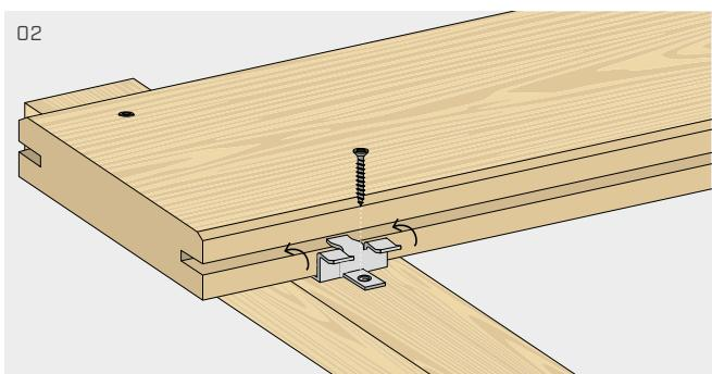
Inserir na ranhura o conector GAP3 de forma que o dente central do grampo esteja aderente à fresagem da tábuas.
