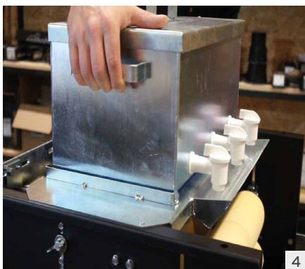
Farbbehälter aufsetzen und sicherstellen, dass die Düsen verschlossen sind. Auffangeimer unter dem Tank einhängen.
