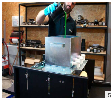
Farbe einfüllen. Bei Bedarf bis zu einer homogenen Konsistenz umrühren.
