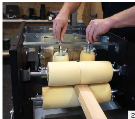
Schwämme an die Dimensionen des Werkstücks anpassen und mit den Schrauben fixieren.
