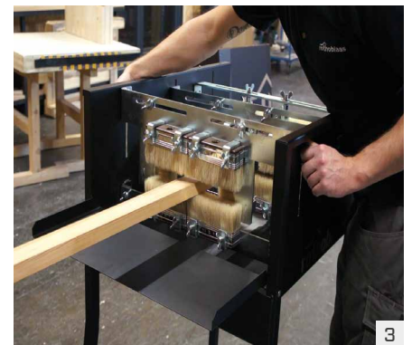
Bürsten an die Dimensionen des Werkstücks anpassen und mit den Schrauben fixieren.
