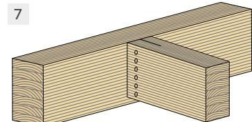
MONTAGE „TOP-DOWN“ | ALUMIDI OHNE LÖCHER MIT OBERER AUSFRÄSUNG
