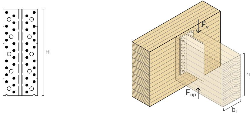
ALUMIDI mit selbstbohrenden Stabdübeln SBD
