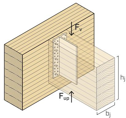
ALUMIDI mit selbstbohrenden Stabdübeln SBD
